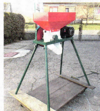
Unaprijeđena drobilica za lješnjake samo je jedna od inovacija u cijeloj liniji strojeva za obradu orašastih plodova
